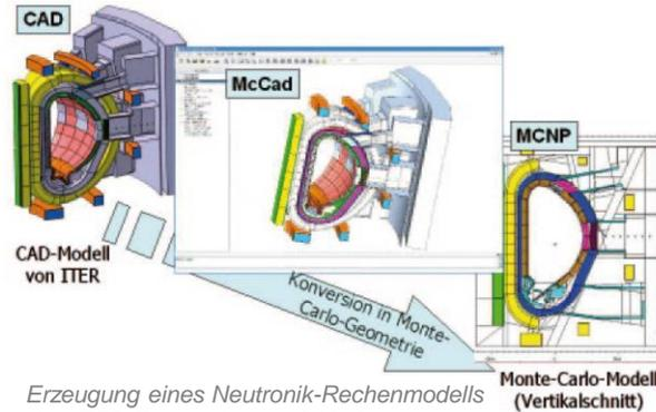
Erzeugung eines Neutronik-Rechenmodells des ITER-Tokamaks aus CAD-Daten
